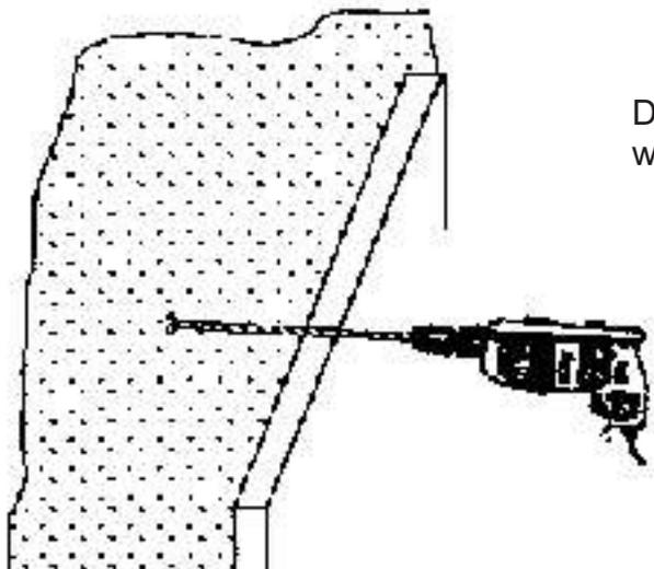
Den langen Bohrer einfach auf die untere Platte auflegen und im Winkel von 90° das erste Dübelloch bohren.
