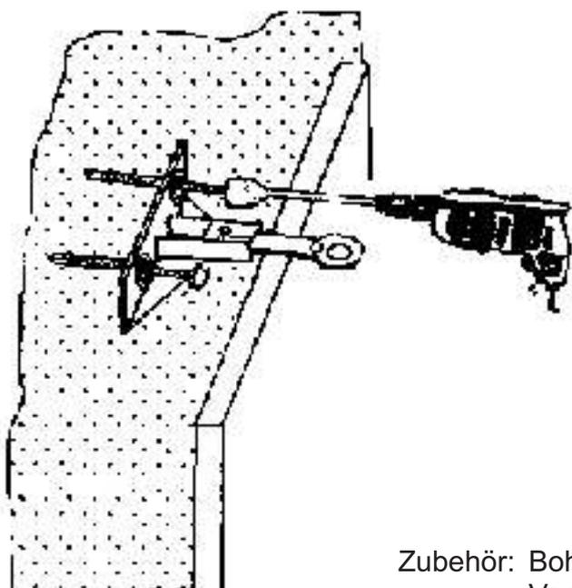
Bohrer gegen eine 13 mm Nuss mit Verlängerung wechseln, den Schlag ausschalten und die Muttern anziehen.
